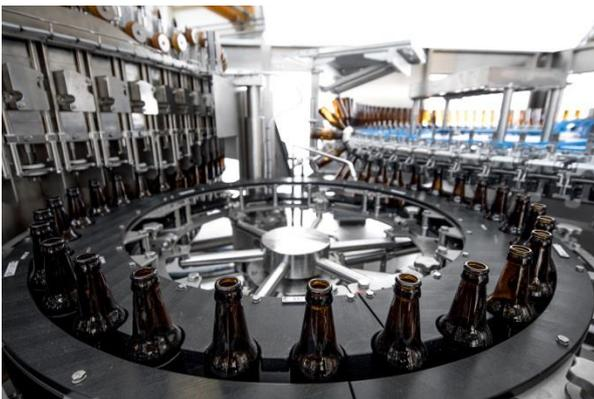
Das neue Design der leichteren und kleineren Formatwechselteile gewährleistet Umstellzeiten unter 30 Minuten mit einem einzigen Bediener.
