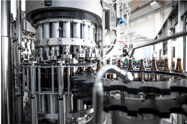
Der hochreine Sidel-Kronkorken-Verschleißer mit seinem offenen Design und dem versetzten Verschleißring fügt dem Abfüllprozess ohne Schmierbedarf ein weiteres Leistungsmerkmal hinzu.
