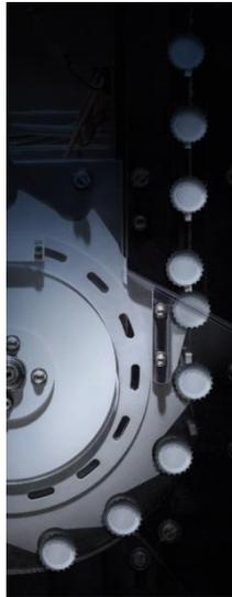
Der Sidel-Füller EvoFILL Glass wird perfekt ergänzt durch die Gebokronkorkenzuführung OptiFEED®, die hochwertige, konforme Kronkorken in einem kompakten Raum zuführt.
